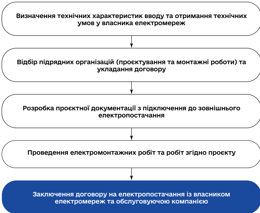
Мал. 8. Етапи підключення до зовнішніх електромереж
